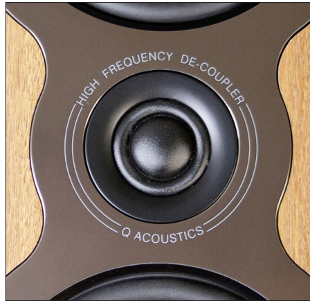
Die 22er-Gewebekalotte sitzt entkoppelt und nach hinten abgeschlossen auf der Frontplatte.
